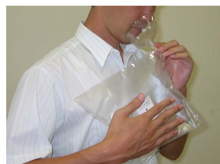
嗅覚を用いたにおいの測定 (三点比較式臭袋法)
